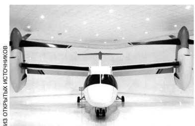
Немного о машине: скорость — до 510 километров в час, дальность — до 2000 километров, девять мест внутри, два двигателя до 1940 лошадиных сил.
