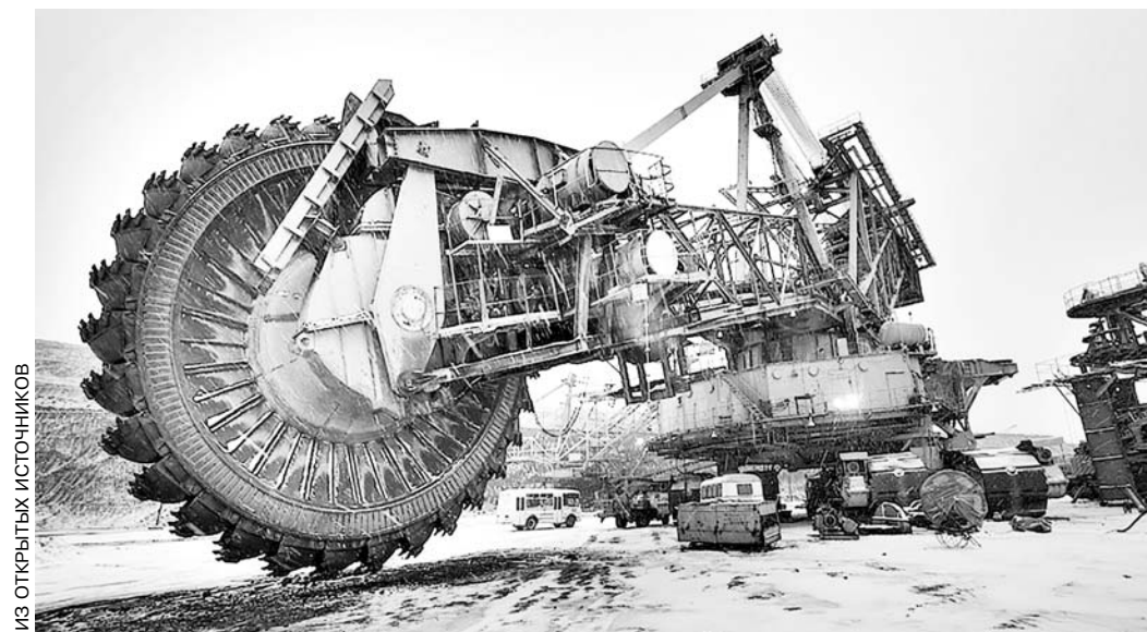
Роторный экскаватор (Экибастузский угольный карьер, разрез Богатырь)
